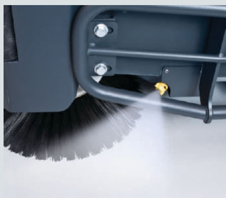
Sistema DustGuard™, que reduz a poeira no ar gerada pela escova lateral, varrendo até 85%;
