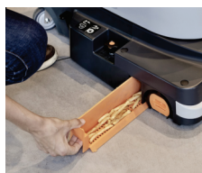
Fácil acesso ao esvaziamento e limpeza da bandeja de detritos
