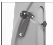
Alavanca mecânica de elevação do rodo localizado na coluna da direção.
