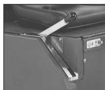
Alavanca mecânica do elevador do convés.
